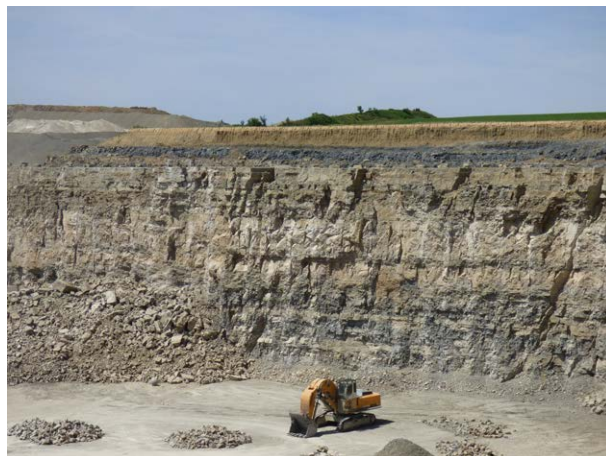
Abb. 2: Abbauwand im Steinbruch Kupferzell-Rüblingen (RG6724-1) bestehend aus grauen und beige Kalksteinen mit Tonmergelsteinlagen der Tonplatten- und Künzelsau-Schichten. Der überlagernde Abraum setzt sich aus dunkelgrauen Tonsteinen der Fränkischen Grenzschiefer und Löss zusammen.
