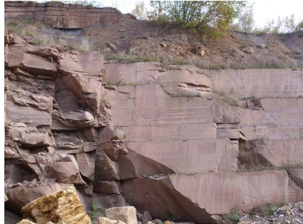
Abb. 2: Abbauwände im Schilfsandstein von Maulbronn: Abbauwand von 2010 im Norden des Großen Steinbruchs mit stark geklüfteter Zone links und weitständig geklüftetem Werksteinlager rechts im Bild; die Gewinnung erfolgte mit der Schwertsäge.
