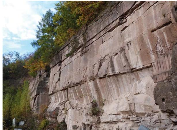
Abb. 4: Typische Steinbruchwand im Maulbronner Schilfsandstein; Westwand im Großen Steinbruch in Maulbronn mit ca. 10 m mächtiger Werksteinzone. (Stand: 2012)
