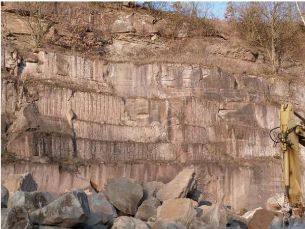
Abb. 3: Abbauwände im Schilfsandstein von Maulbronn: alte Abbauwand im Ostteil des Großen Steinbruchs mit Spuren von Bohr- und Spaltarbeiten; über dem aufgeschlossenen, 11 m mächtigen Sandsteinpaket treten graue und rötliche Tonsteine mit einer geringmächtigen Sandsteinbank auf. (Stand: 2012)
