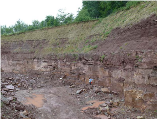
Abb. 1: Blick nach Nordwesten auf die ca. 15 m mächtige Abbauwand des ehemaligen Steinbruchs Remchingen-Wilferdingen (RG 7017-1). Im Liegenden nutzbare Werksteinbänke der Plattensandstein-Formation (soPL) mit überlagernden plattigen Sandstein, gefolgt von Ton- und Schluffsteinen der Rötton-Formation (soT). Im Hangenden gelbliche bis beige Ton- und Dolomitsteine des Wellendolomits (muF). (Stand: 2007)
