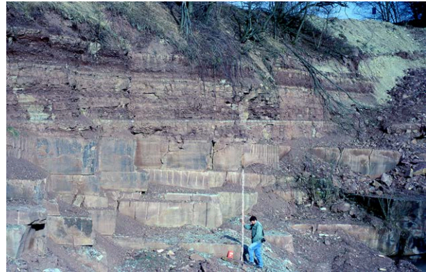
Abb. 4: Blick nach Nordosten auf die Abbauwand des Steinbruchs Tiefenbronn-Mühlhausen (RG 7118-1). 3 bis 4 m Werksteinzone unter plattigen Sandsteinen der Plattensandstein-Formation (soPL) und Tonschluffsteinen der Rötton-Formation (soT). Diskordanzen in den Sedimenten zeigen Veränderungen der Schüttungsrichtungen sowie der Paläomorphologie an. Das Abraum-/Nutzschichtverhältnis liegt hier zwischen 1:1 bis 2:1. (Stand: 2003)
