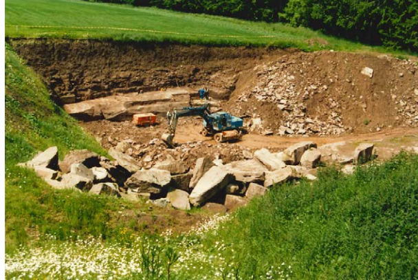
Abb. 2: Blick nach Westen in den ehemaligen, mittlerweile vollständig verfüllten und rekultivierten Steinbruch Lossburg-Sulzbach (RG 7516-1) aus dem Jahr 1987. Im Vordergrund bereits abgebaute Rohblöcke. Im Hintergrund die Abbauwand mit überlagernden Abraum aus Tonschluffstein (soT) und plattigen Sandstein (soPL) sowie unterlagerndem Werksteinbänken des Plattensandsteins (soPL). (Stand: 1987)
