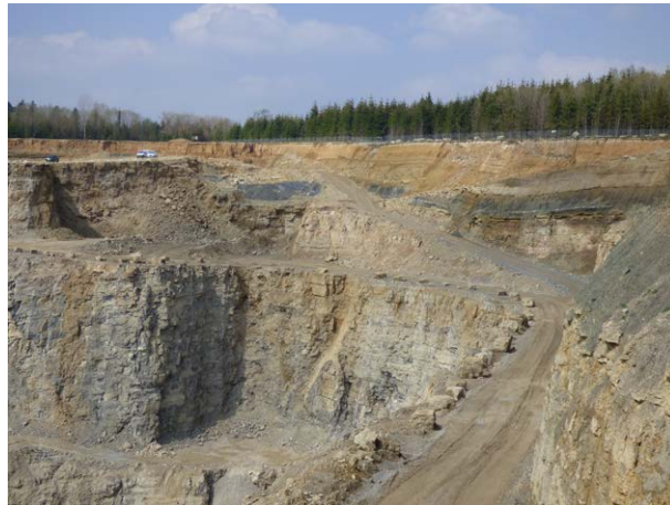
Abb. 2: Der Abraam im Steinbruch Sulz a. N.-Fischingen (RG 7618-3) setzt sich aus Ton-, Mergel-, Dolomit- und Sandsteinen der Erfurt-Formation (kuE) sowie Lösssedimenten des Quartärs zusammen. Die deutliche Mächtigkeitszunahme des Abraams in der Bildmitte im Vergleich zum linken Bildrand ist zwei WNW-ESE streichende Abschiebungen zurückzuführen.
