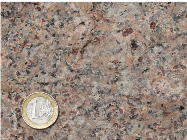
Abb. 3: Triberg-Granit: Rote, mittel-bis grobkörnige Varietät, Steinbruch Schramberg (Steinbruch-Nr. RG 7716-1)
