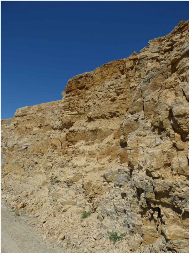
Abb. 1: Obere Abbausohle im Steinbruch Dürrenmettstetten (RG7617-1). Im unteren Bereich sind graue plattige Kalksteine der Plattenkalke zu erkennen, die nach oben in bankige, beige Dolomitsteine des Trigonodusdolomits übergehen.
