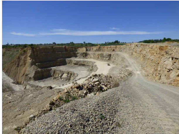
Abb. 2: Im Steinbruch Dürrenmettstetten (RG7617-1) werden Kalksteine der Trochitenkalk- und Meißner-Formation gewonnen. Der Abbau erfolgt mittels Bohrungen und Sprengungen.
