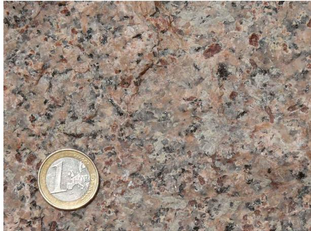
Abb. 2: Tribberg-Granit: Rote, mittel-bis grobkörnige Varietät, Steinbruch Schramberg (Steinbruch-Nr. RG 7716-1)
