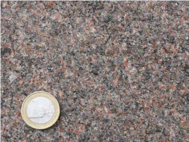
Abb. 1: Tribberg-Granit: Rötliche, fein bis mittelkörnige Varietät, Steinbruch Tennenbronn (Steinbruch-Nr. RG 7816-1).
