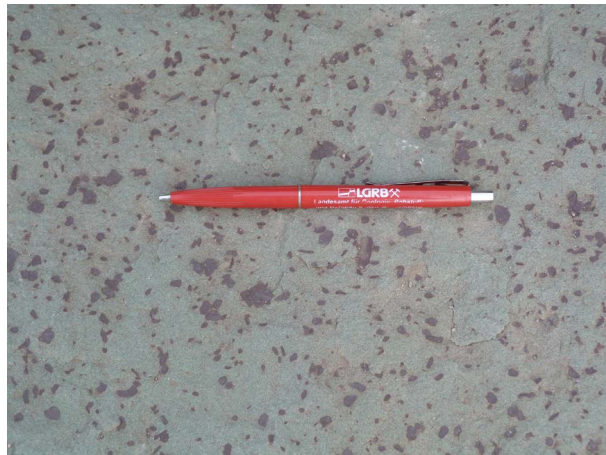
Abb. 2: Dickbankiger, hellgrünlicher, Hellglimmer führender Schilfsandstein (Renfrizhauser Sandstein, Schichtoberfläche) mit mm- bis cm-großen, dunkelrotvioletter Tonschmitzen; aus dem Steinbruch Sulz am Neckar-Renfrizhausen (RG 7618-9).
