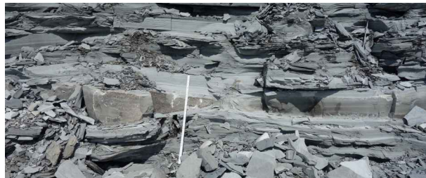
Abb. 4: Bituminöse Tonsteine mit Kalksteinbänken der Posidonienschiefer-Formation im Steinbruch Dormettingen (RG 7718-4). Diese Gesteine werden vor allem wegen ihres Energieinhalts und ihrer gleichzeitig günstigen mineralischen Zusammensetzung zur Erzeugung von Portlandzement verwendet.
