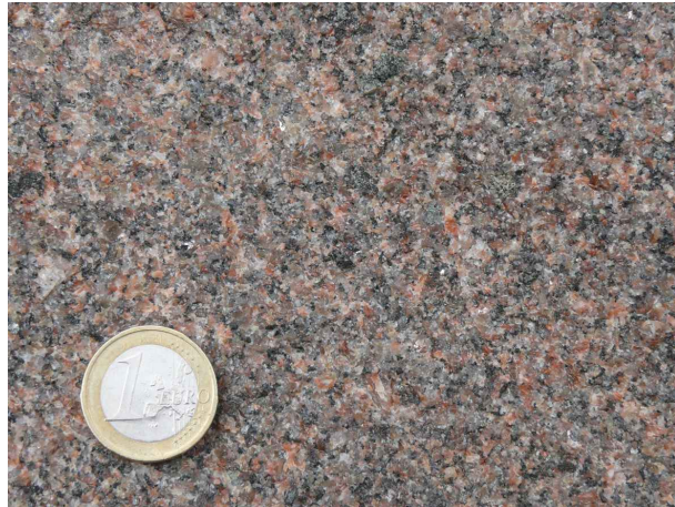
Abb. 2: Triberg-Granit: Rötliche, fein bis mittelkörnige Varietät, Steinbruch Tennenbronn (Steinbruch-Nr. RG 7816-1).
