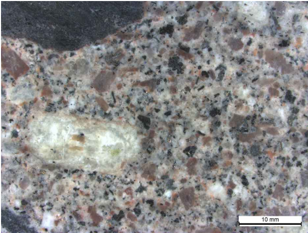
Abb. 1: Mikroskopische Aufnahme eines porphyrisch-feinkristallinen Ganggranit aus dem Steinbruch Gropptal (RG 7816-2). Das Gestein besteht aus Einsprenglingen von mittelkristallinen Kalifeldspat, Quarz und Biotit sowie grobkristallinen, zonierten und leistenförmigen Plagioklas. Die Grundmasse besteht aus denselben Mineralen. Im Bild oben links sieht man ein Fremdgesteinsbruchstück (sog. Xenolith) aus Biotit-reichem Paragneis.
